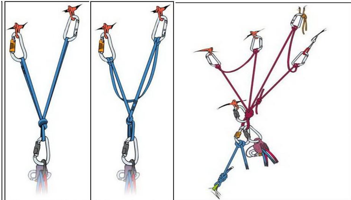
slika 3: varovanje na nezanesljive fiksne točke: fiksno trikotno sidrišče, nastavljivo trikotno in t.i."hobotnica") - nastavljivo sidrišče na več točk, tu dodatno fiksirano proti potegu navzgor. Vir: DAV
